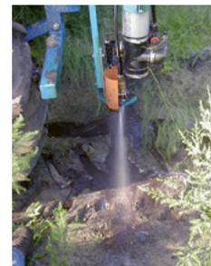
Déterminez le calibre de la buse en fonction des critères de sélection suivants : débit, vitesse du pulvérisateur et pression de pulvérisation recommandée pour le type de buse.
