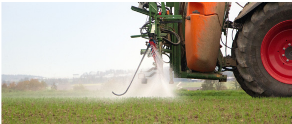
Couverture optimale grâce au double jet plat
