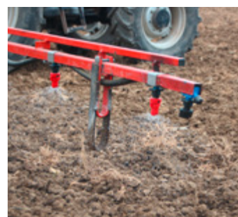
Buses XDT pulvérisant un herbicide de pré-levée
