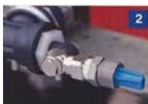
Fixation des buses sur montage articulé 2 pour modifier l'orientation des jets
